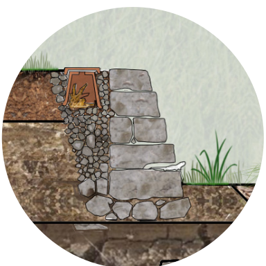
Mur en pierres sèches et cavités
